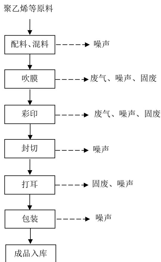
图 2-2 塑料袋生产工艺流程及产污环节图
