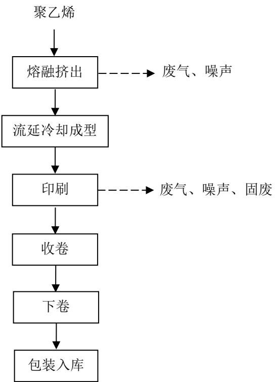
图 2-3 流延膜生产工艺流程及产污环节图
