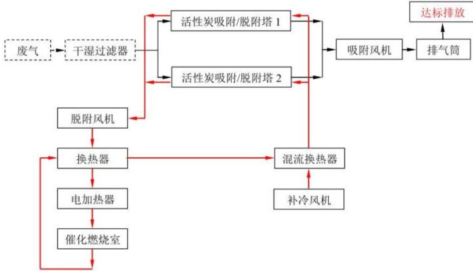
图 4-1 催化燃烧设备工艺流程图
