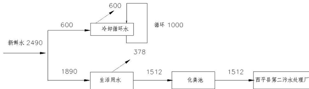
图 2-1 项目水平衡图 单位：m<sup>3</sup>/a
