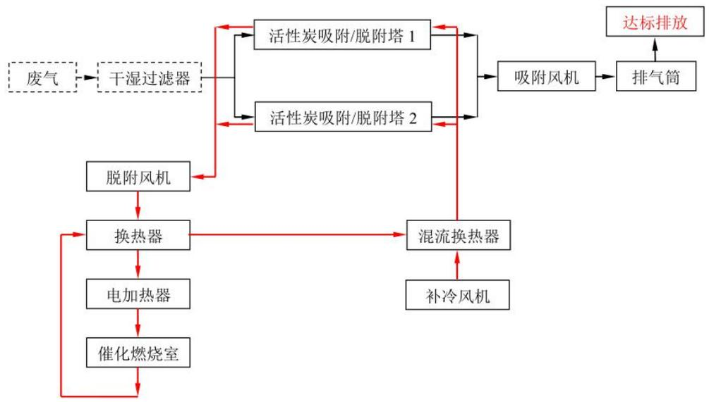
图四 催化燃烧设备工艺流程图
