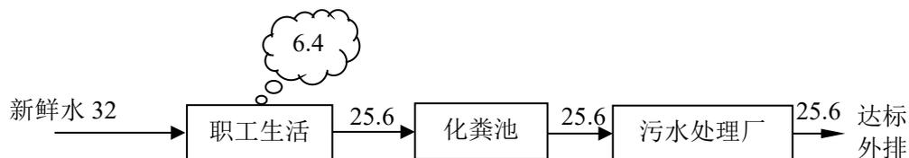
图一 本项目水平衡图 (单位:  $\text{m}^3/\text{a}$ ; ☁️ 表示蒸发损失量)
