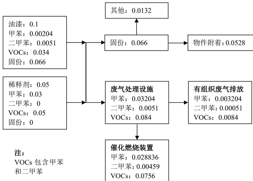
图二 本项目油漆物料平衡图 (单位: t/a)
